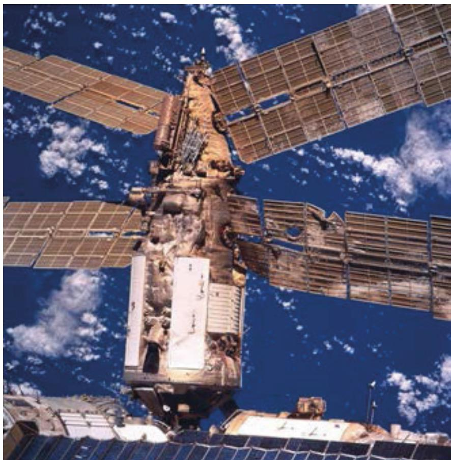
Повреждённый модуль «Спектр» после столкновения с грузовым кораблём «Прогресс-М34», 1997 год
